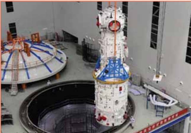
Boven: tijdens haar derde testvlucht maakt Ingenuity deze opname van de rover Perseverance en haar landingsplaats. [NASA/JPL] Links: de 16,6 meter lange Tianhe, het eerste element van het nieuwe Chinese modulaire ruimtestation, wordt in een thermische vacuümkamer gehesen. [CAST] Rechts: De Crew Dragon Resilience, met de bemanning nog aan boord, wordt op het dek van het bergingsschip gehesen kort na de landing in de Golf van Mexico. [SpaceX]
