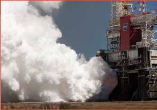
Op 18 maart worden de vier RS25 motoren van de SLS Core Stage gedurende de volledige duur van 500 seconden getest. De SLS Core Stage wordt later naar het Kennedy Space Center verscheept voor de eerste Artemis vlucht rond de komende jaarwisseling. [NASA]
