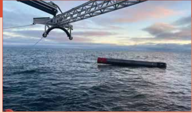
De eerste trap van de Electron raket kort voordat deze door Rocketlab uit zee wordt geborgen. [Rocketlab]
