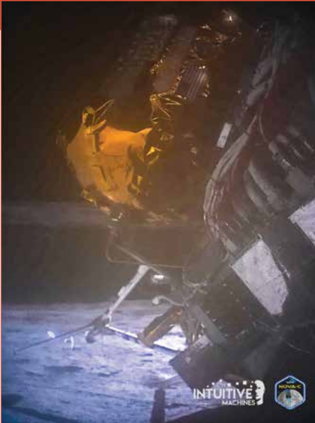
Op deze na de landing gemaakte foto is zichtbaar dat Odysseus scheef staat en dat het landingsgestel beschadigd is. [Intuitive Machines]
