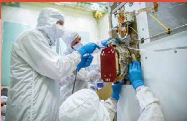
Technici van SRON en Airbus NL monteren SPEXone op de PACE-satelliet op NASA Goddard Space Flight Center. [NASA]
