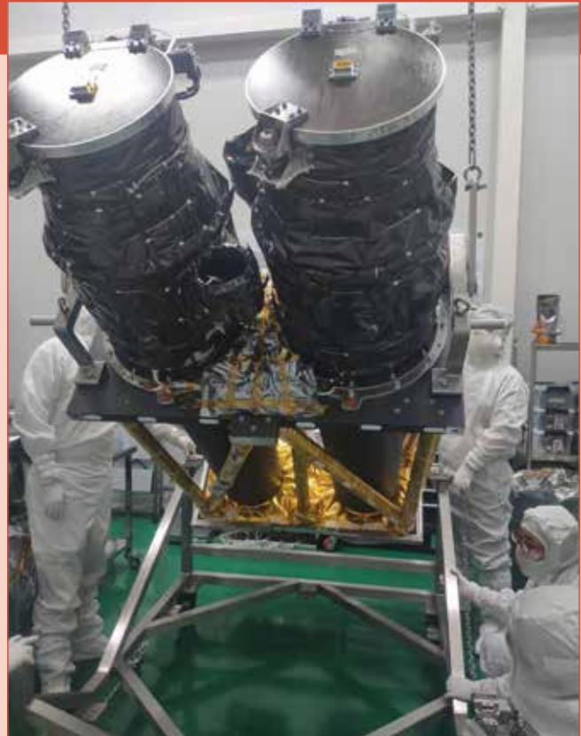
Technici bereiden de installatie voor van de Fast X-ray Telescope (FXT) in de Einstein Tanzhen satelliet. [CASC]
