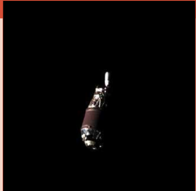
Deze tweede trap van een H-2A raket draait al sinds 2009 rond de Aarde, als zij gefotografeerd wordt door de ADRAS-J satelliet. [Astroscale]
